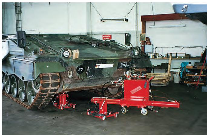
Machine de levage mobile pour véhicules à chenilles
